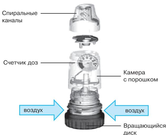
Рис. Устройство порошкового ингалятора Турбухалер
